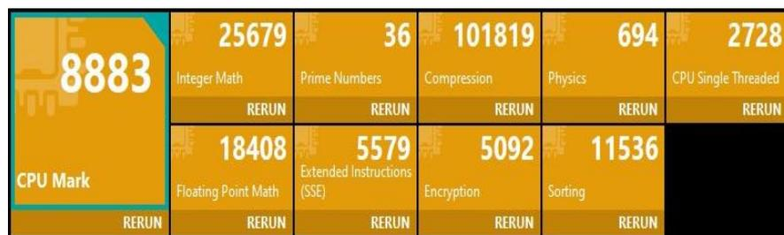
Gambar 3. Hasil Pengujian Intel Core i7-1265U Menggunakan *Passmark v. 11. 1*
